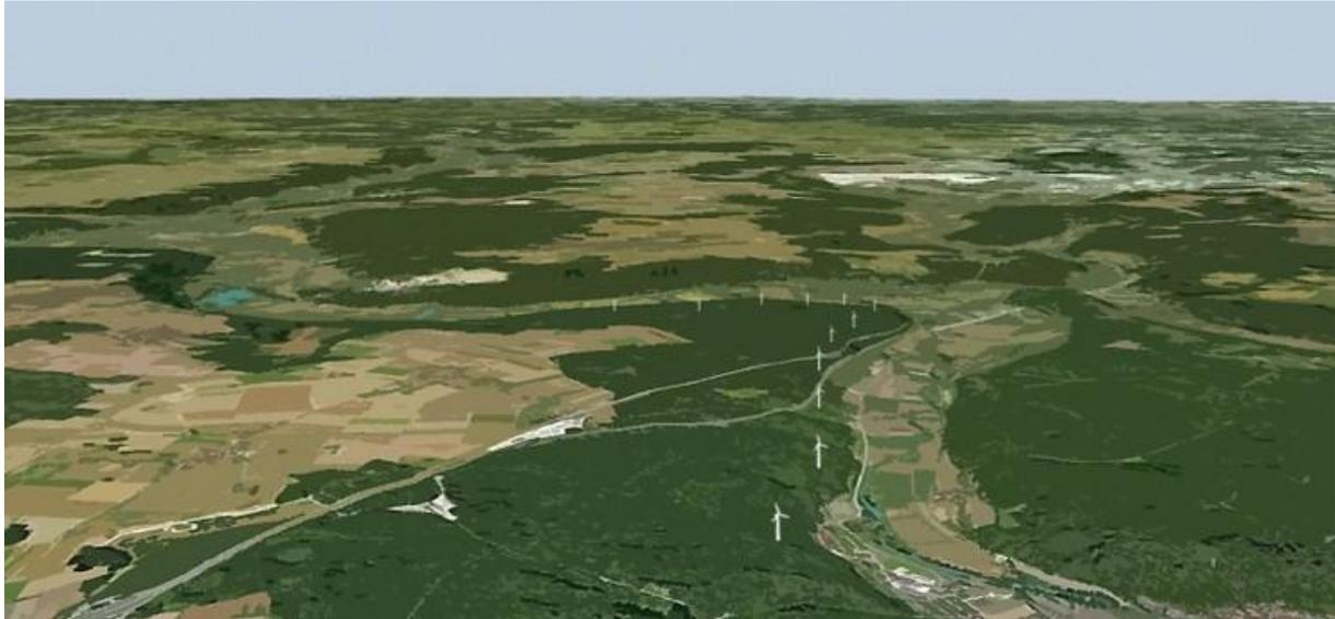
**Abbildung 1: Computersimulation: Morphologiebezogene Anordnung eines Windparks (SCHÖBEL 2012)**
