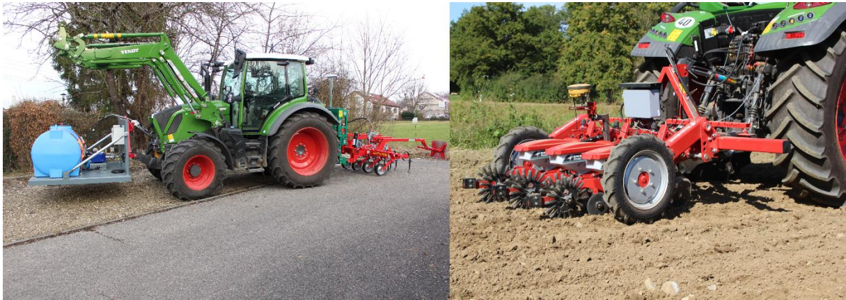
Abb. 28: Links im Bild ist der Stand des Prototyps im Januar 2024 zu sehen. Rechts ist die Sämaschine mit integrierter Messtechnik abgebildet.
