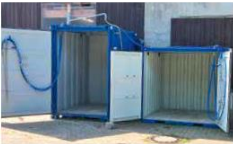
Abb. 22: Bedampfungscontainer der Firma Gebhardt Anlagentechnik GmbH & Co KG in unterschiedlichen Größen mit Messtechnik auf dem LVB Jungborn der HfWU
