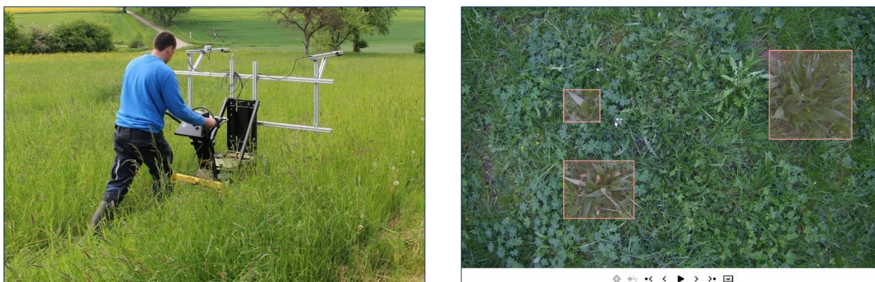
Abb. 26: (a) Mobiles Kameragestell bei der Aufnahmefahrt. (b) Manuell markierte Herbstzeitlosen in den aufgezeichneten Videos
