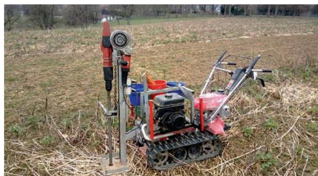
Entnahme von Bodenproben
