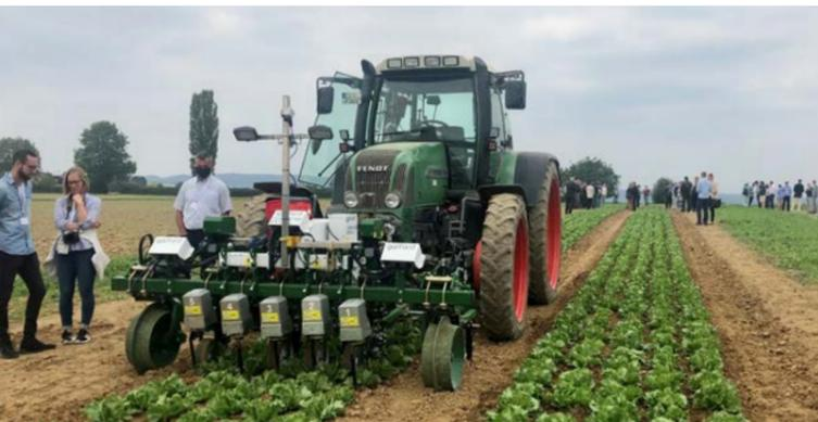
Ein mit Kamera und Sensor gesteuerter Jätroboter während einer der Feldvorführungen beim DiWenkLa-Tag.
