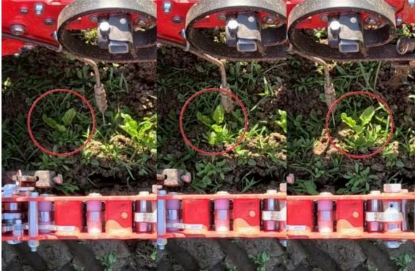
Abbildung 42: Schaltvorgang der Wasserdüse beim Feldeinsatz mit Applikationskarte
