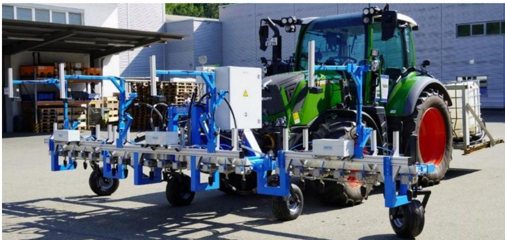
Abbildung 34: Neues Wasserstrahlgerät mit 6 Meter Arbeitsbreite und 24 Hochdruckdüsen sowie 4 Kameras zur Pflanzendetektion (Foto: Mattheis/MartinEnergietechnik)
