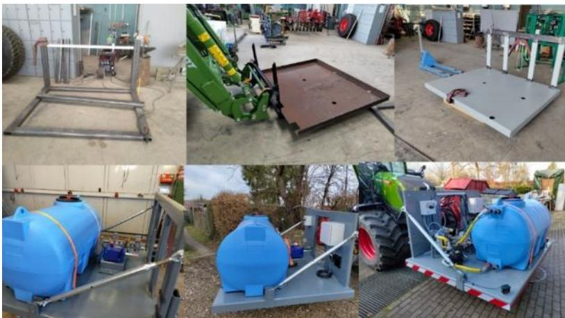
Abbildung 39: Baufortschritt der selbst konstruierten und gebauten Frontplattform
