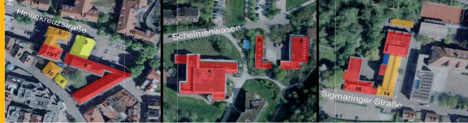
Abbildung 9: Eignung für Photovoltaik auf den Dächern von Campus Innenstadt, Braike und Hauber. Blau = nicht geeignet, gelb = geeignet, orange = gut geeignet, rot = sehr gut geeignet. Stadt Nürtingen (2010): Solardachinfo
